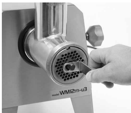
Rys.8. Wyciąganie ślimaka za pomocą chwytaka
