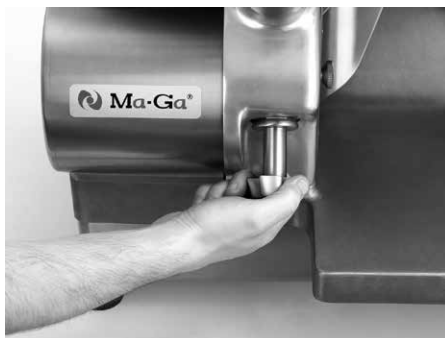
Rys. 9. Odkręcanie śruby ściągającej
